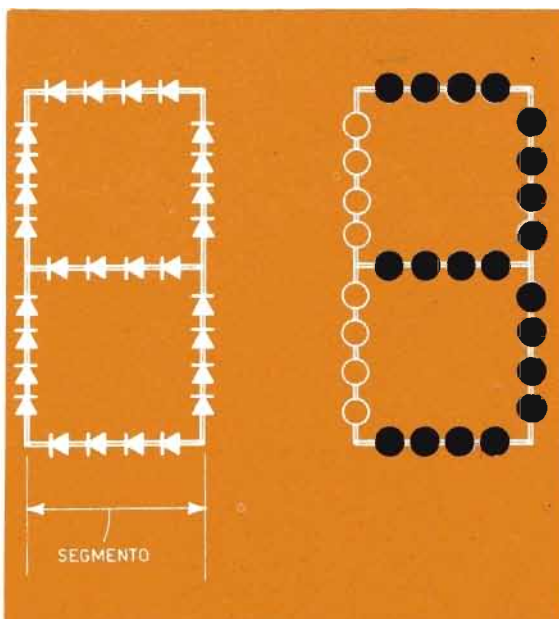
Fig. 26 - I diodi a luce rossa vengono impiegati abbondantemente nella formazione di numeri dei display. Alimentando soltanto una parte di diodi, cioè una parte dei sette segmenti, è possibile ottenere la riproduzione dei numeri.
