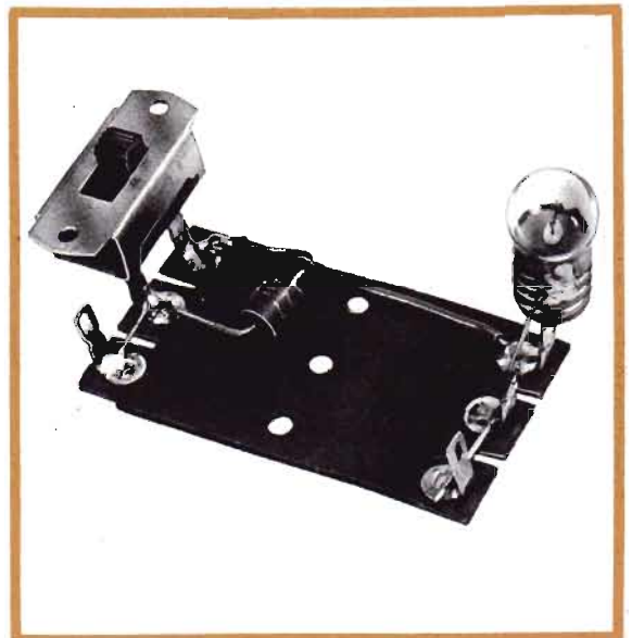
Fig. 7 - Questa foto propone il cablaggio dell'esperimento atto a dimostrare la presenza di una tensione di barriera in tutti i tipi di diodi.
